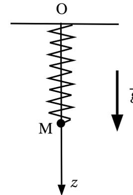
**1. a)** Écrire l'équation du mouvement du point  $M$  ; quelle est la pulsation propre  $\omega_0$  du système ?
