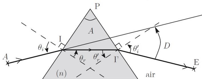
On constate expérimentalement l'existence d'un minimum de la valeur de  $D$  lorsqu'on fait varier l'angle d'incidence. On note  $D_m$ ,  $\theta_{i,m}$ ,  $\theta'_{i,m}$ ,  $\theta_{r,m}$  et  $\theta'_{r,m}$  la valeur des angles au minimum de déviation.
