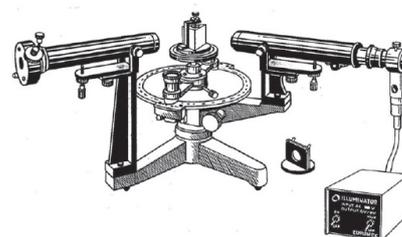
Le prisme est réalisé dans un milieu solide transparent d'indice de réfraction  $n$ , d'arête P et d'angle au sommet  $A = \pi/3$ . Le prisme est dans l'air d'indice de réfraction 1.
